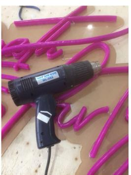
チューブ接続部分 ガラスネオンでは出来ない加工がLEDチューブではできます。
